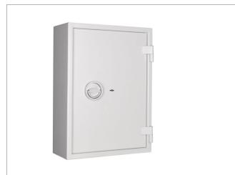
Zur sicheren Verwarung von Autoschlüsseln in kleinen und mittelständischen Betrieben. Diese Tresore sind mit einem Doppelbart-Hochsicherheitsschloss mit 2 Schlüsseln ausgestattet. Die Tür ist doppelwandig (58 mm dick) mit 3-seitiger Verriegelung durch Schließbolzen (20 mm Durchmesser). Die Feuerisolierung wird durch umlaufenden Feuerfalz gewährleistet.
